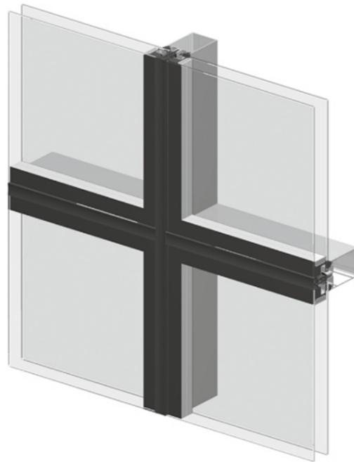
**Vitrages** de 36 à 42 mm pour les parties vision fixes et ouvrantes. Panneaux d'allège opaques avec vitrages de 6 ou 8mm ou panneaux isolants de 40 à 120 mm.
